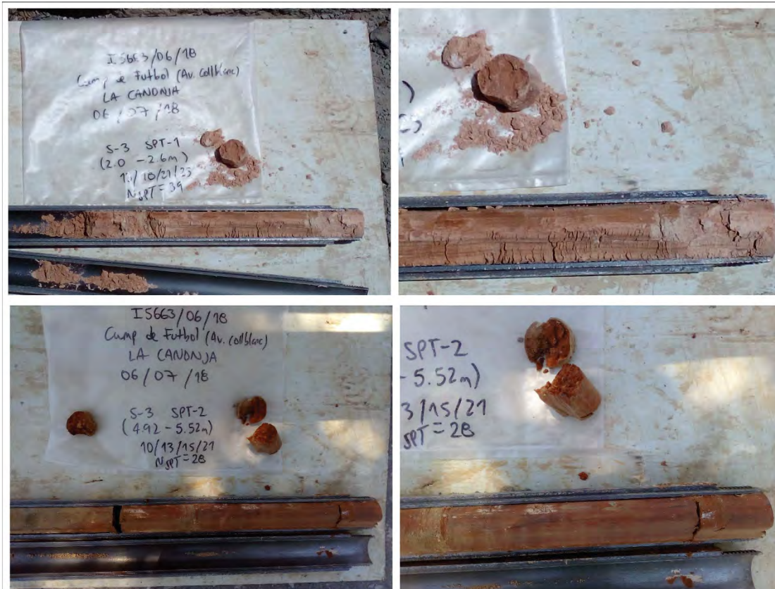
Vistes dels materials del subsòl extrets en dos assaigs SPT realitzats al llarg del sondeig S-3.
