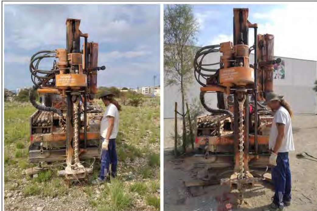
Vistes de dos dels cinc sondeigs realitzats a la zona objecte d'estudi, S-4 i S-5 del tipus Rotació helicoidal.
