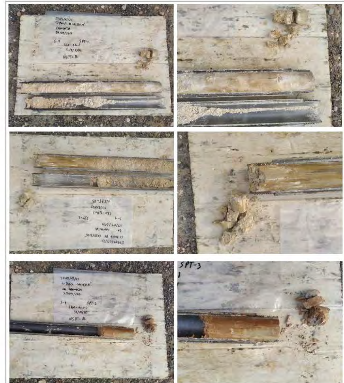
Vistes dels materials del subsòl extrets en tres assaigs SPT realitzats al llarg del sondeig S-1.
